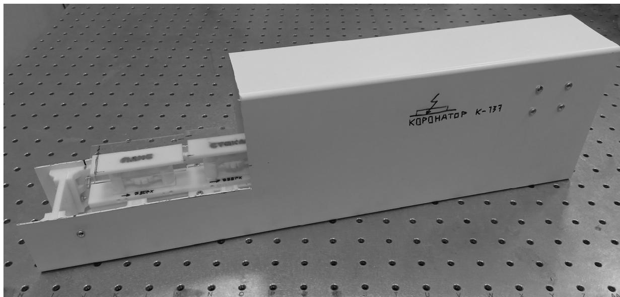
Рис. 1. Изображение экспериментального прототипа автоматизированного устройства по обработке поверхностей полимеров и стекол коронными разрядами для изготовления микрофлюидных чипов
